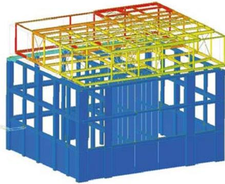
↑ Modello di calcolo realizzato con il software di calcolo Midas Gen (distribuito da CSPFea, Este - PD).
